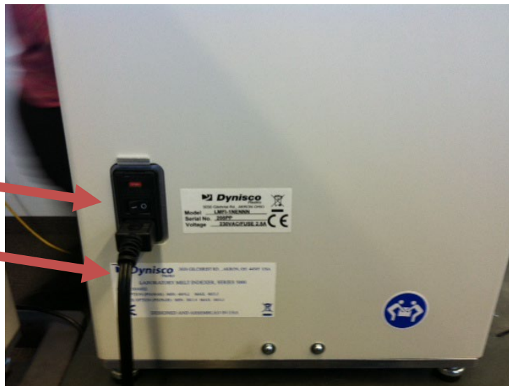
Figura 3: Vista posteriore del LMFI - Collegamenti dell'alimentazione
